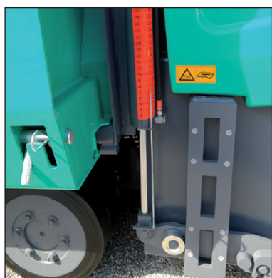
Figure 1.20 – Fixation du bras de traction et du vérin de nivellement
