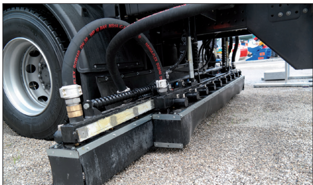
Figure 1.15 – Rampe de répandage
