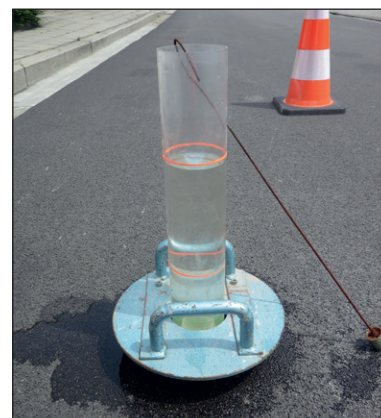
Figure 5.6 – Mesure du pouvoir drainant
