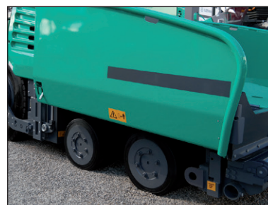
Figure 1.24 – Finisseur sur pneus
