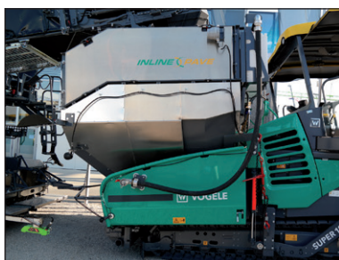
Figure 1.55 – Trémie supplémentaire sur le finisseur
