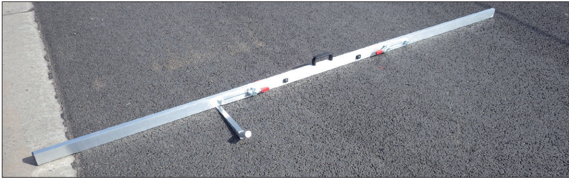
Figure 5.2 – Mesure à la règle de 3 m
