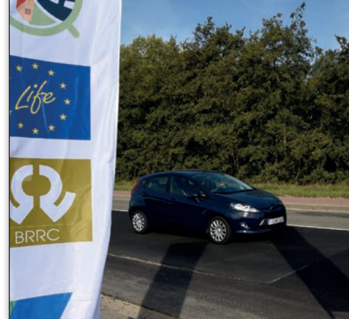
Des mesures effectuées sur la section expérimentale poroélastique ont démontré une réduction acoustique de 7 à 9 dB
