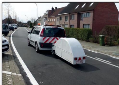
Figure 4 – Remorque de mesure de la résistance au roulement (RRR1) du CRR dans la Kleine Doornstraat à Wilrijk
